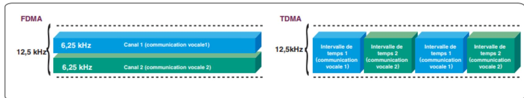
Jusqu'à présent le système TDMA était plus efficace avec un espacement plus large entre voies tel que 25 kHz, puisque deux ou trois utilisateurs pouvaient accéder à la même bande passante que l'utilisateur unique d'un canal FDMA. Cependant, dans le cas de la technologie récemment développée de bande FDMA étroite 6,25 kHz, cette dernière et la technologie TDMA 12,5 kHz à 2 slots obtiennent le même résultat en ce qui concerne l'indice d'occupation spectrale.
