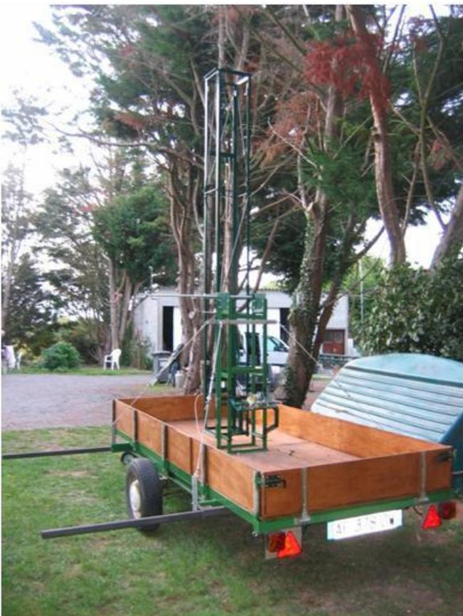
L'axe de basculement est pour l'instant provisoire, c'est-à-dire une tige filetée de diamètre 14 mm !!!
