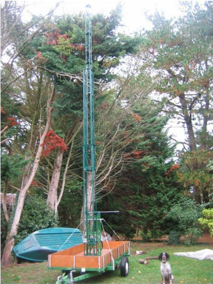
Premiers essais de développement vertical du pylône, toujours avec un axe de basculement provisoire pour la démonstration et validation de la conception. Le setter anglais tricolore du maître surveille les opérations !!!
