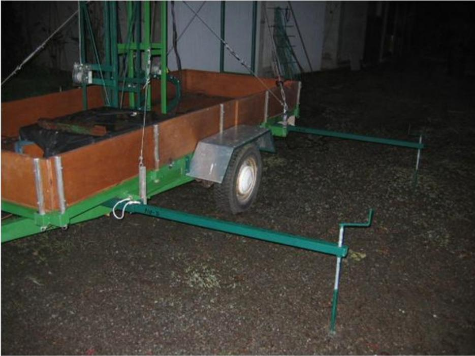
Des stabilisateurs rétractables permettent d'assurer la stabilité de l'ensemble en position haute qui se situe à 8,50mètres du sol sous le rotor, donc des aériens vers les 9 mètres sol.
