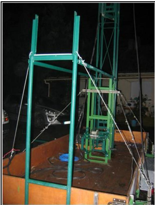
Une vue du support arrière de repos et les divers haubanages de l'ensemble.
