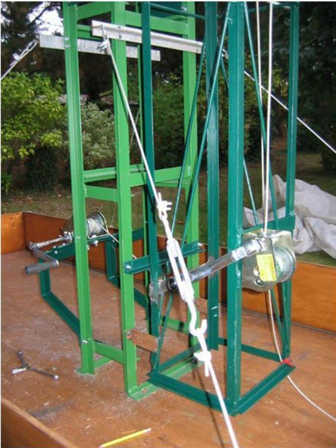
Premiers essais d'ajustements après la mise en place du treuil de basculement.
