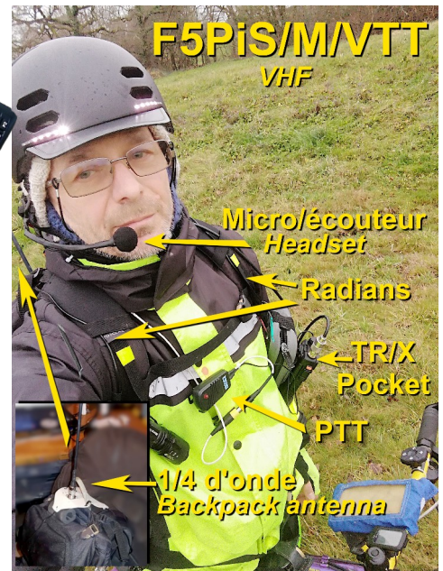
Récepteur bluetooth à l'arrière. L'antenne du TX est à 15/20 cm
