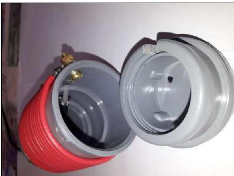
L'embout fileté est entaillé pour permettre le passage de la tête de vis intérieure avant collage. Le bouchon fileté d'obturation d'extrémité est muni d'un joint torique permettant l'étanchéité.
