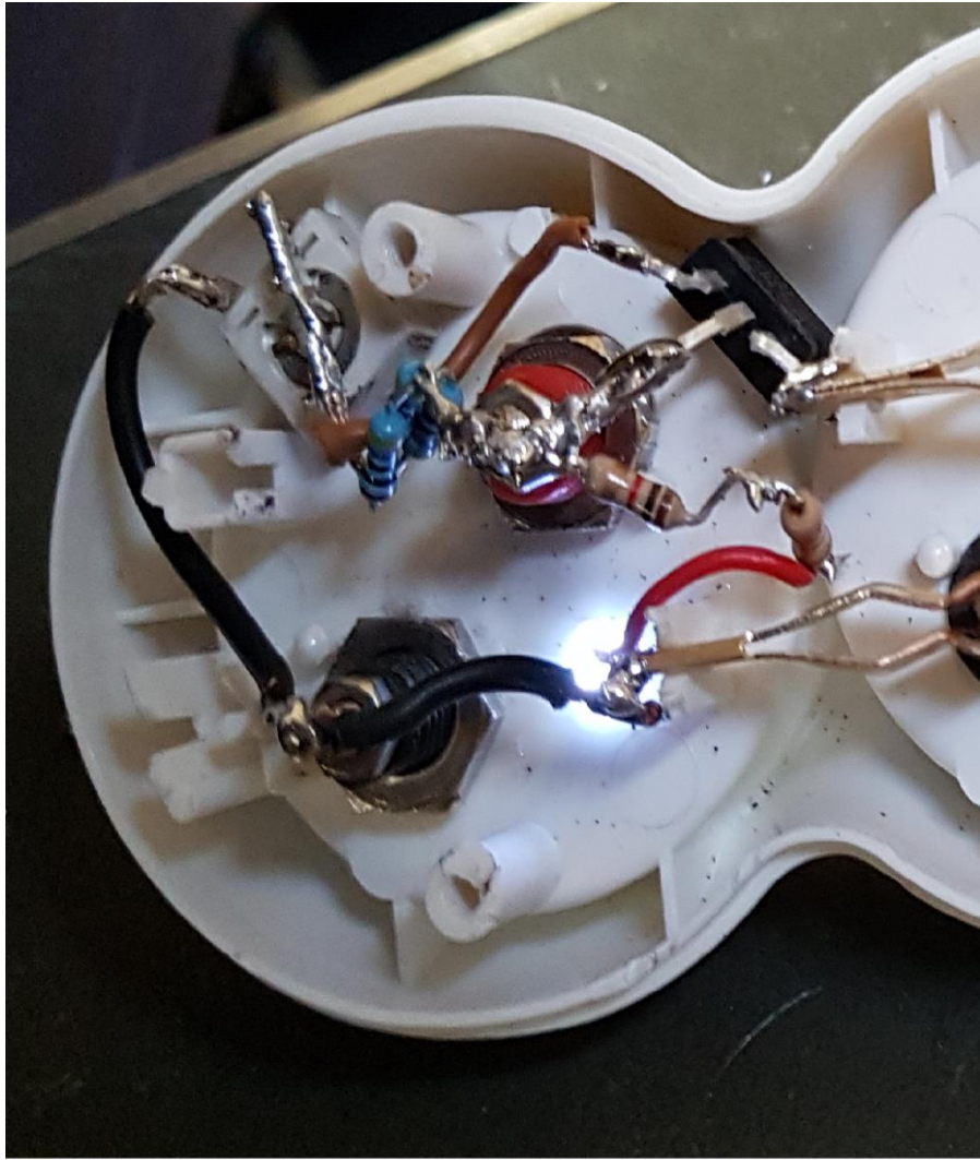
En gros plan, le montage « pattes en l'air » de la sortie 5v.
