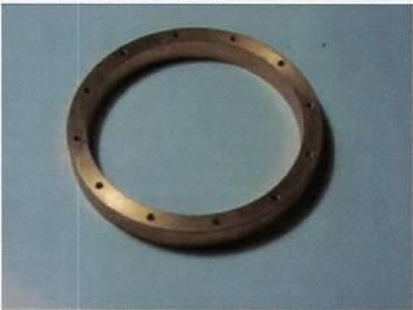
Couronne centrale de la cavité
